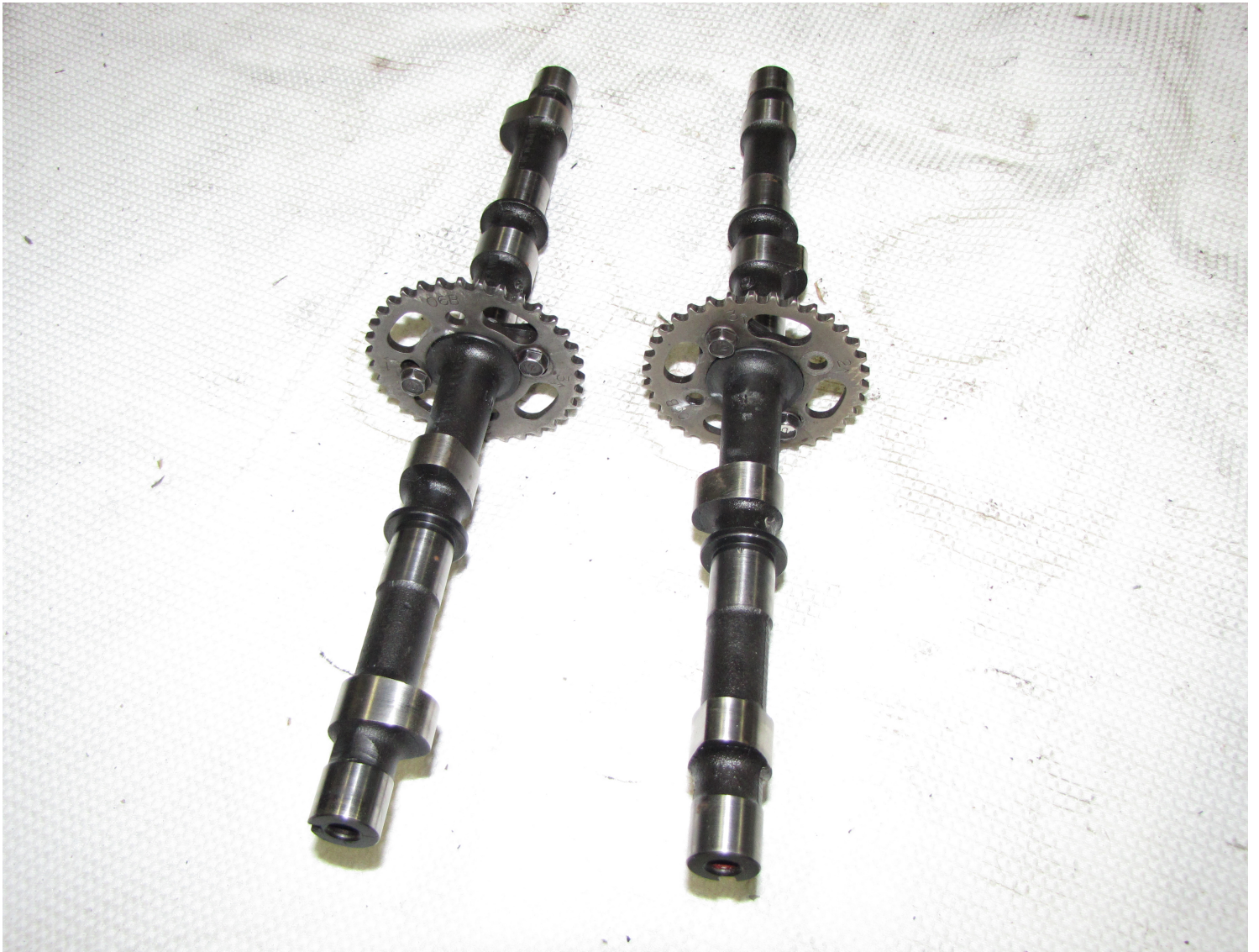
N° 2 alberi a camme riprofilati corona asolata per cambio fasatura Suzuki GSXR
